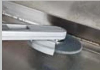
Con el disco de tela medio los cordones de soldadura se lijan hasta conseguir el perfil deseado. La piedra perfiladora permite adoptar la forma adecuada de los discos de tela.
