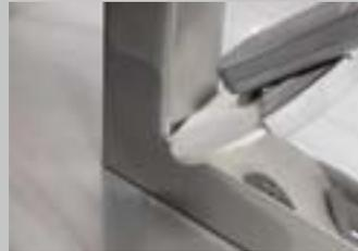
Con el disco de fieltro y las pastas de pulido, los cordones de soldadura pueden pulirse hasta el brillo espejo.
