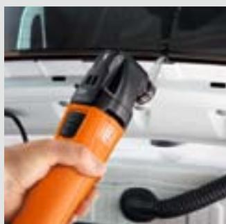
Для извлечения герметичных боковых и задних стекол изнутри используются L-образные ножи в трех различных исполнениях длиной до 38 мм.
