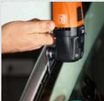
Используется L-образный нож, производительность резки которого на 40 % превосходит производительность U-образного ножа при одинаковой скорости. Повреждения кузова практически исключены. Рекомендуемая степень скорости: 3–4.
