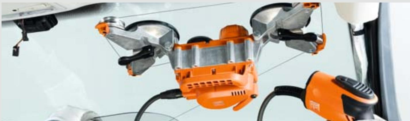
Если систему SUPERWIRE невозможно установить с телескопическими рычагами, ее необходимо переставить один раз. После прокладки проволоки система SUPERWIRE крепится вверху справа. Стекло вырезается до верхней кромки, после этого система SUPERWIRE смещается влево, и вырезается оставшаяся часть стекла.
