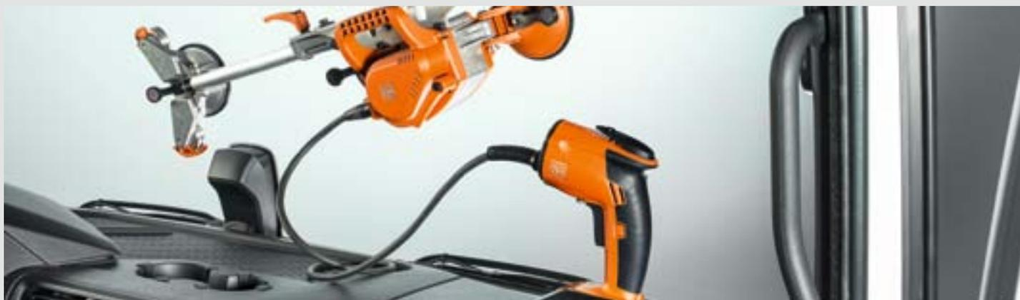
Однократная перестановка системы SUPERWIRE позволяет безопасно вырезать стекла в грузовых автомобилях. Начинать следует с правой стороны автомобиля. Стекло вырезается примерно до середины внутренней поверхности крыши. После этого система SUPERWIRE переставляется на левую сторону стекла.
