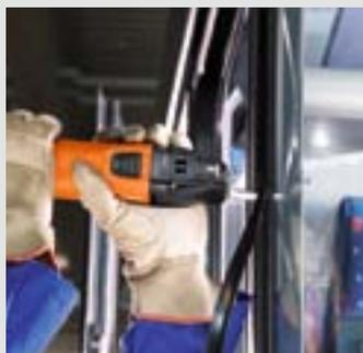
Перед извлечением стекол у автобуса сначала следует удалить швы V-образным разрезом. Благодаря быстрому резу для этого идеально подходит прямой разрезной нож модели 073. Рекомендуемая степень скорости: 3–5.
