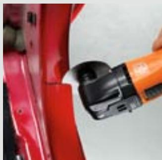
Пильное полотно из быстрорежущей стали позволяет эффективно и без искрообразования разрезать кузовные панели толщиной до 1 мм, а также большинство полимерных материалов, в том числе стеклопластик. Ширина реза составляет всего 0,5 мм. Не подходит для резки высокопрочных кузовных панелей. Рекомендуемая степень скорости: 3–5.
