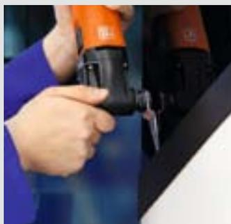
Приклеенные защитные планки быстро и без повреждений удаляются с помощью прямых ножей моделей 081 и 216. Благодаря этому планки в большинстве случаев можно использовать повторно. Рекомендуемая ступень скорости: 3–5.
