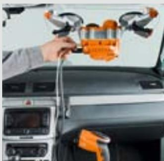
С помощью кабеля, поставляемого в качестве принадлежности, активируется система Anti-Metal-Cut. Акустический сигнал раздается прежде, чем проволока могла бы повредить кузов автомобиля.
