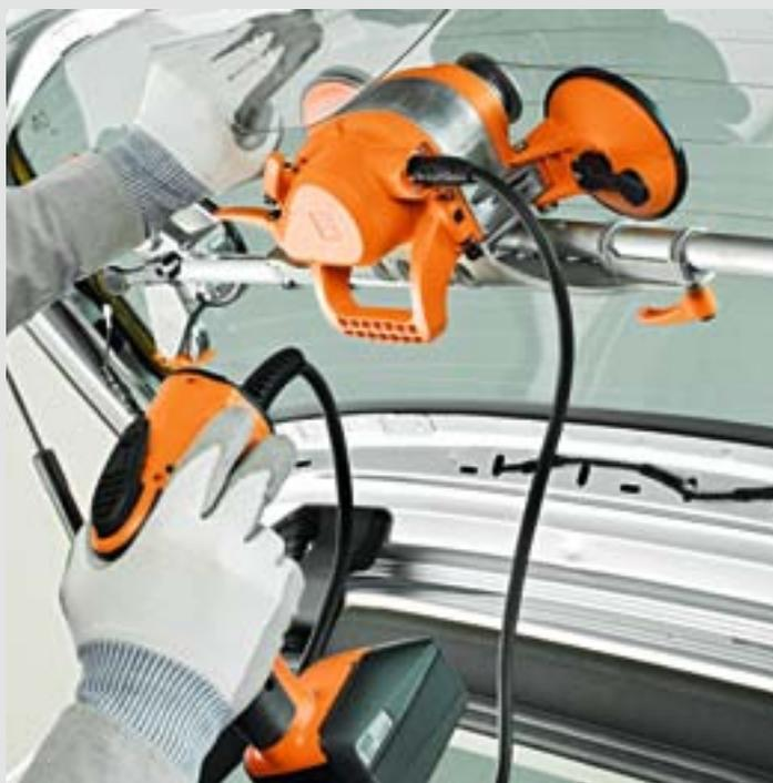
При низких задних стеклах, например, в автомобилях с кузовом универсал, система SUPERWIRE устанавливается параллельно окну.
