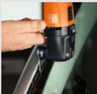
В случае небольших зазоров (мин. 3 мм) используются L-образные ножи моделей 207 и 208 в исполнении 25,4 или 19 мм. Укороченная форма позволяет сэкономить время на демонтаже внутренней облицовки передних стоек кузова автомобиля.
