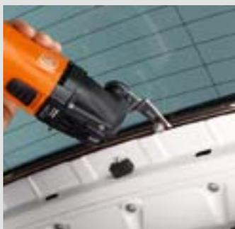
Боковые и задние стекла легко и быстро снимаются изнутри с помощью разрезного ножа модели 143 и регулируемого упорного ролика. Рекомендуемая степень скорости: макс. 3.
