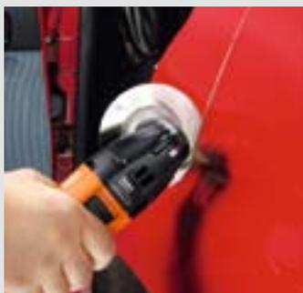
Пильные полотна из быстрорежущей стали позволяют легко разрезать стандартные кузовные панели толщиной до 1 мм, а также детали из твердых полимерных материалов и стеклопластика. При этом ширина реза составляет всего 0,5 мм. Другие преимущества: рез без искрообразования и индивидуальная регулировка глубины врезания в материал.
