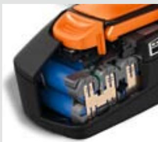
Продуманная электронная схема позволяет контролировать все элементы батареи по отдельности и защищает аккумулятор от перегрузки, перегрева и полной разрядки.
