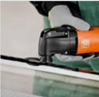
Грибовидный разрезной нож позволяет быстро и легко разрезать стеклопакеты у автобусов и рельсовых транспортных средств. Кроме того, с его помощью легко удаляются остатки клея на стекле.
