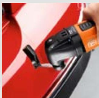
Прямой зубчатый разрезной нож модели 081 позволяет снимать вклеенные пластмассовые и навесные детали, например молдинги или бамперные накладки. Разрезной нож модели 073 оптимально подходит для изготовления дополнительных прорезей, например, при обработке пластмассовых бамперов.
