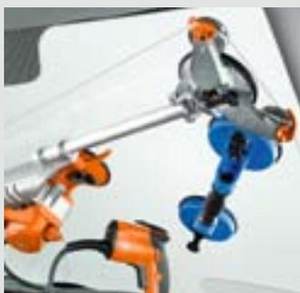
В редких случаях телескопический рычаг может соскальзывать со стекла. Этого можно избежать с помощью обычного вакуумного держателя.
