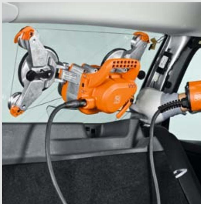
Демонтаж телескопического блока и переустановка направляющих роликов непосредственно на приводной блок позволяют вынимать даже маленькие боковые окна без перестановки инструмента.
