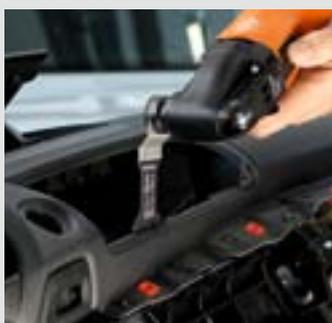
Пильные полотна E-Cut с биметаллическими зубьями оптимально подходят для кузовных работ, особенно в труднодоступных местах или на изгибах, во время ремонта или переоборудования автомобиля (например, при установке навигационных устройств).
