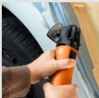
Переоборудование для прецизионного шлифования позволит эффективно справиться с небольшими ремонтными работами, такими как удаление ржавчины и следов от удара камней или устранение повреждений лакокрасочного покрытия, даже в труднодоступных местах кузова. Дополнительные преимущества обеспечат комплект шлифовальных пластин и переходник для инструментов с системой QuickIN и без нее.
