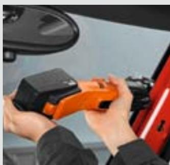
Если внешний зазор между стеклом и кузовом составляет менее 3 мм, стекло следует вырезать изнутри с помощью прямого ножа. Рекомендуемая ступень скорости: макс. 3.
