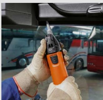
Mediante il coltello di forma 081 è possibile rimuovere con facilità dall'interno anche vetri di grandi dimensioni. Velocità consigliata: livello 3-5.
