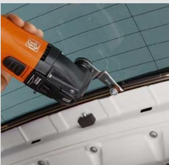
Mediante il coltello di forma 143 e l'anello di battuta regolabile è possibile rimuovere dall'interno in modo facile e veloce i vetri dei finestrini laterali e del lunotto. Velocità consigliata: livello max. 3.
