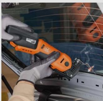
Il coltello con la forma 143 è dotato di un rullino di battuta regolabile, con cui si possono rimuovere i cristalli dei veicoli in modo rapido e sicuro. Velocità consigliata: max. livello 3.
