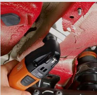
Mediante la spatola è possibile rimuovere in modo facile e rapido la protezione del sottoscocca e le protezioni antipietrisco. I punti da riparare possono essere messi a nudo facilmente e, ad es., i ganci di attacco rimorchio possono essere avvistati direttamente al telaio. Velocità consigliata: livello 2-4.
