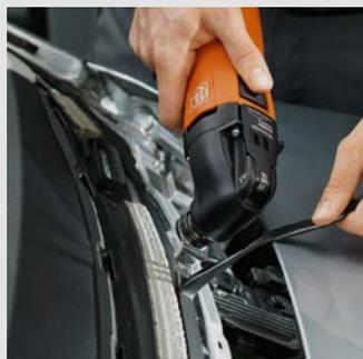
Mediante il raschietto è possibile rimuovere i residui di collante in modo preciso e veloce senza troppo sforzo. Velocità consigliata: livello 2-3.
