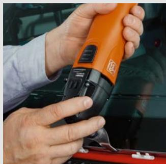
Per la rimozione del vetro da sotto il cofano motore trovano impiego i coltelli a forma di U. Velocità consigliata: livello 3-5
