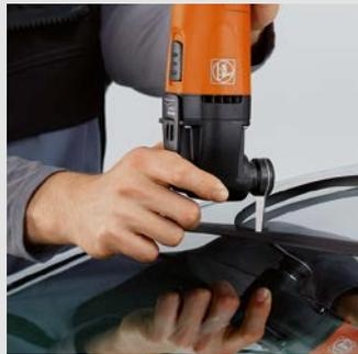
Con il coltello a forma di L è possibile rimuovere in un'unica operazione parabrezza incapsulati e telai vulcanizzati, anche con rinforzo in alluminio. Velocità consigliata: livello 3-4.
