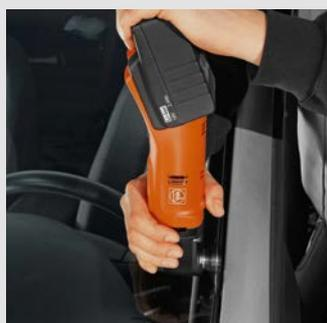
Taglio estremamente veloce: il coltello a L, forma 207, ha, a parità di velocità e caratteristiche, una velocità di taglio del 40% superiore rispetto a un coltello a U. Un grande vantaggio durante la sostituzione dall'esterno di parabrezza. Velocità consigliata: livello 3-4.
