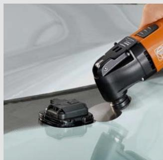
La nuova gamma di accessori è ideale anche per altre applicazioni. Con il coltello a fungo, ad esempio, è possibile rimuovere facilmente i sensori per luci e tergicristalli, spesso presenti nei veicoli di ultima generazione. Velocità consigliata: livello 2-3.
