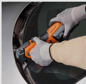
Per rimuovere i vetri da sotto il cofano motore si utilizzano coltelli rinforzati a forma di U. Velocità consigliata: livello 3-4.
