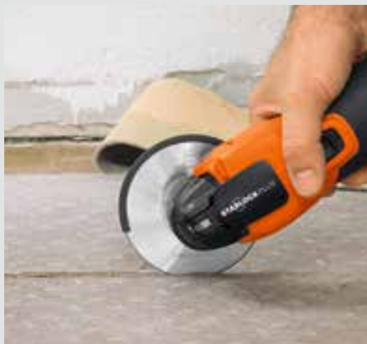
Fjern gamle gulvbelegg raskt og enkelt og uten rester.
