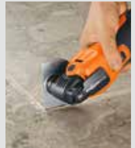
Diamantsegmentkniv til skjæring i hjørneområder.
