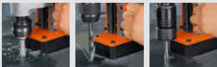
Perçage par carottage
