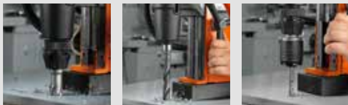
Perçage par carottage
