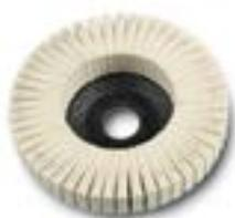
Pour le polissage et le prépolissage de l'acier inoxydable. Les lamelles empêchent que le feutre ne « brûle » et permettent ainsi un polissage uniforme. Utiliser uniquement avec de la pâte à polir (Prépolissage = Pâte de prépolissage, Polissage brillant = Pâte de polissage). Diamètre : 125 mm
