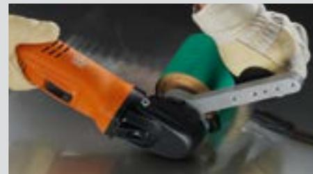
Ponçage de surfaces avec des manchons abrasifs pour un rendement exceptionnel.
