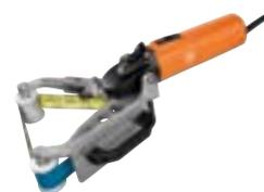
Ponceuse pour tubes avec rendement maximal pour tubes droits et coudés en acier inoxydable d'un diamètre jusqu'à 80 mm. Réglage en continu de la vitesse de rotation pour le ponçage, le satinage et le poli miroir de mains courantes.
