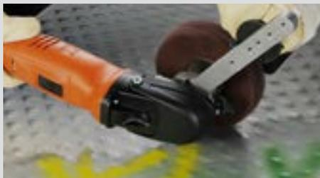
Nettoyage et finition rapides et efficaces de grandes surfaces avec des disques fibre plissés.
