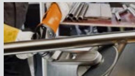
Poncer les soudures d'angle : du ponçage des cordons de soudure au poli miroir.
