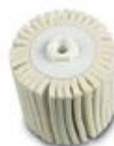
Pour le polissage et le prépolissage de l'acier inoxydable. Les lamelles empêchent que le feutre ne « brûle » et permettent ainsi un polissage uniforme. Utiliser uniquement avec de la pâte à polir (Prépolissage = Pâte de prépolissage, Polissage brillant = Pâte de polissage). Diamètre : 100 mm. Longueur : 100 mm.
