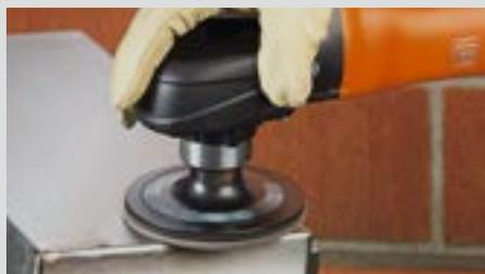
Éliminer efficacement les couleurs de revenu avec le disque fibre plissé ou disque fibre.
