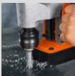
Perforación con corona
