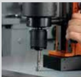
Maschiatura con dispositivo di maschiatura
