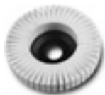
Filz Fächerscheibe Zum Polieren und Vorpolieren von Edelstahl. Durch die Lamellen „verbrennt“ der Filz nicht und es kann ohne Streifenbildung poliert werden. Nur mit Polierpaste verwenden (Vorpolieren = Vorpoliercreme, Hochglanzpolieren = Abglänzcreme).
