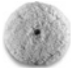
Lammwollhaube Durchmesser ca. 230 mm für Schleifteller Ø 170 mm 6 38 06 187 01 0 M 14 mit Klettenhaftsystem. Empfohlene Arbeitsdrehzahl 500 - 1 200 U/min. Qualität: TOPWOOL, Frisbee-Polierscheibe. Lammwolle/Synthetik-Mischung, auswaschbar.
