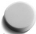
Polierschwamm Zum Polieren von lackierten Oberflächen. Unterschiedliche Härtegrade: weich für Neulacke, mittel für leichte Verwitterung und Wachsaufrag, hart für stark verwitterte Lacke. Klettenschnellbefestigung, Höhe 40 mm.
