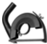
Utsugskåpa med styrsläde för kapskivor Ø 180 mm, skärdjup 40 mm, anslutning Ø 32 mm
