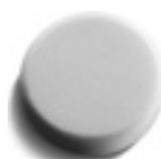
Polersvamp För polering av lackerade ytor. Olika hårdhetsgrader: mjuk för ny lack, medium för lätt flagning och vaxapplicering, hård för mycket flagad lack. Kardborrfäste, höjd 40 mm.
