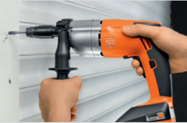
짧은 사이클 시간 제조 시간 절약: 리버스 기어 박스는 나사 홈에서 복귀할 때 자동으로 회전 방향을 역전시킵니다. 사이클 시간은 670rpm의 고속 역회전을 통해 단축됩니다.
