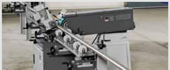
La guida tubi, anch'essa disponibile come accessorio opzionale, permette di lavorare senza problemi tubi dai diametri più disparati, con una lunghezza massima di 6 mt.
