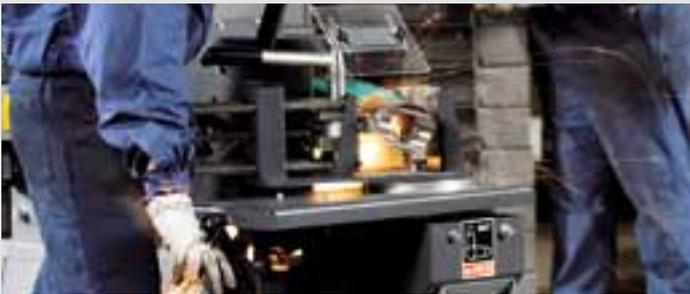
Il modulo di sglatura GRIT GIR è stato sviluppato appositamente per l'impiego industriale. Grazie alla struttura robusta può essere utilizzato in modo prolungato e, nella lavorazione di materiali spessi o pieni risulta redditizio e preciso.
