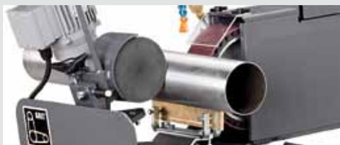
La fornitura comprende diversi tipi di guide di scorrimento adatte alle diverse caratteristiche superficiali dei pezzi in lavorazione. La guida di scorrimento in ottone è progettata per superfici che presentano irregolarità dovute ad es. a corrosione, calamina ecc., oppure per la levigatura a secco. Per la finitura finale delle superfici e per i materiali più delicati la guida in nylon è la scelta perfetta.
