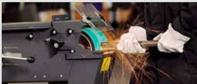
La soluzione ideale per l'utilizzo della levigatura a nastro in applicazioni standard. Il potente motore a corrente trifase, abbinato allo speciale disco di contatto scanalato GRIT e ai nastri abrasivi ad alte prestazioni GRIT, assicura un'eccellente velocità di lavorazione e risultati perfetti anche in caso di utilizzo prolungato.
