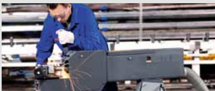
Non importa se dovete sgolare tubi, profili o materiale pieno, il modulo di sgolatura GXR è l'equipaggiamento ideale. E la dotazione è di serie: per esempio la slitta trasversale regolabile in modo esatto e rapido secondo l'angolazione richiesta oppure la morsa con ganasce in acciaio inox con bloccaggio rapido garantiscono lavorazioni precise e sicure.
