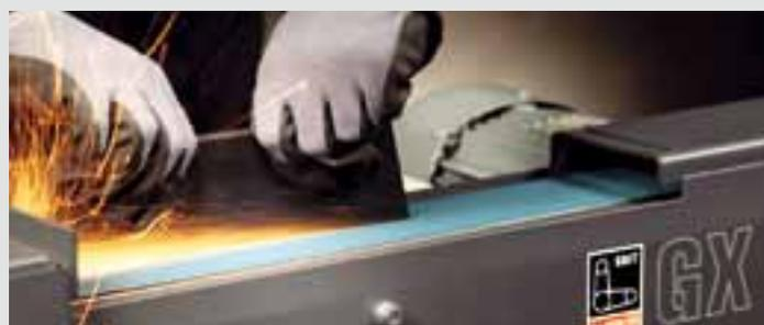
La lavorazione di pezzi in piano è il punto di partenza del programma GRIT. Le caratteristiche peculiari di entrambe le macchine GX 75 sono la grande superficie di levigatura di 75 x 420 mm, il tavolo di lavorazione regolabile in altezza e il semplice sistema di regolazione del nastro.
