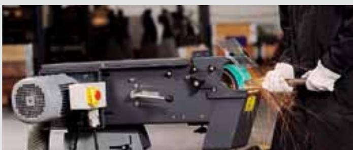
Grazie alla potenza del loro motore, le levigatrici a nastro GX 75 offrono prestazioni elevate. Viene garantita un'elevata capacità di asportazione. Le GX 75 e GX 75 2H sono caratterizzate durante l'impiego da vibrazioni molto contenute e dal sistema brevettato di tensionamento del nastro abrasivo: i lavori di precisione risultano così più facili.
