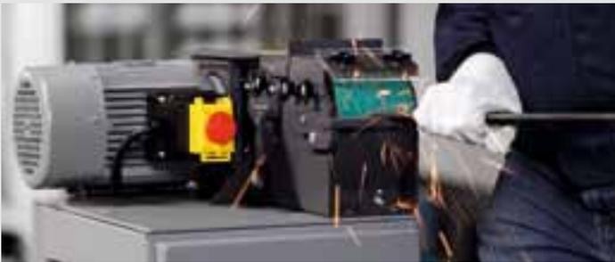
Ideale per levigare, smussare, sbavare piccoli pezzi. In combinazione con il supporto a colonna GRIT GIXBE, la polvere di lavorazione viene aspirata attraverso un filtro per polveri sottili.
