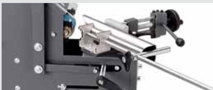
Il dispositivo di arresto di finecorsa per il modulo di sgolatura GXR assicura nelle produzioni in serie una precisa riproducibilità di lavorazione. Il montaggio può avvenire semplicemente in un secondo tempo ed è regolabile fino alla lunghezza di 1000 mm.
