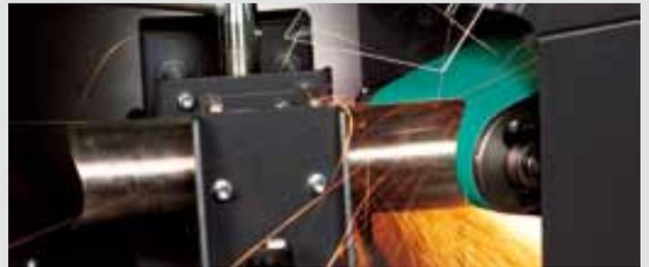
Grazie al sistema di serraggio rapido, il cambio pezzo con la morsa di bloccaggio Heavy-Duty avviene in modo semplice e razionale. Le ganasce in acciaio inox fornite in dotazione prevengono il rischio di corrosione da contatto dei pezzi in acciaio inox. Per un'efficace aspirazione, è necessario l'apposito manicotto (numero d'ordine 6 99 02 182 00 0).
