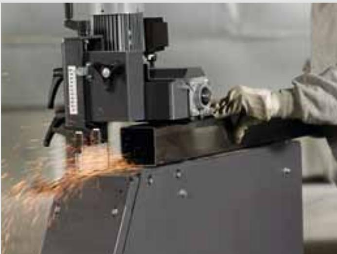
Anche la levigatura longitudinale di profili, materiali piatti o quadri risulta sorprendentemente semplice con il modulo di smerigliatura per superfici piane GILS. Tutto ciò senza modificare le dimensioni del nastro abrasivo della macchina base. Per questa soluzione GRIT è stata depositata domanda di brevetto.
