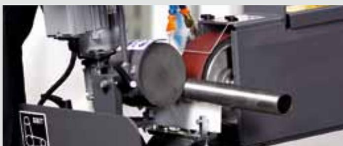
Il modulo di levigatura per tubi tondi GRIT GXC abbina a una perfetta qualità della superficie un'elevata velocità di lavorazione di tubi e cilindri. La velocità di avanzamento può essere regolata in modo continuo in base al materiale in lavorazione, fino a max. 2 metri al minuto.
