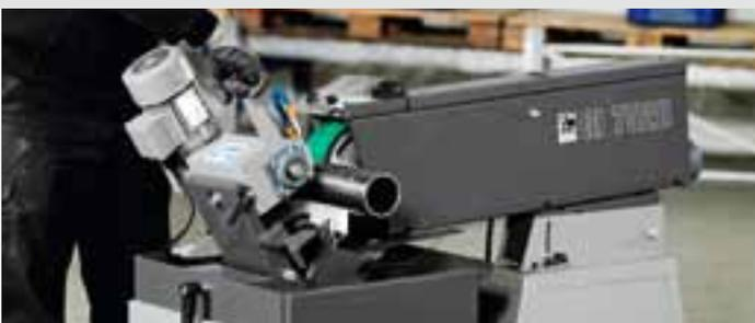
Efficiente levigatura automatizzata di tubi tondi – dalla sgrossatura alla finitura superficiale. In combinazione con il modulo di lubrorefrigerazione GRIT GXW è possibile ottenere risultati perfetti grazie alla bassa temperatura di lavorazione.
