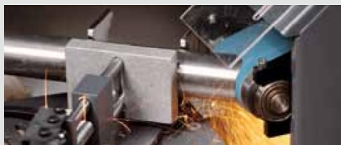
La vasta gamma di rulli di contatto GRIT è pensata per tutti i tubi dei diametri più comunemente utilizzati. Il modulo di sgolatura può così sgolare con precisione tubi di  $\varnothing$  da 16 a 75 mm, con angolazione compresa tra 30° e 90°.
