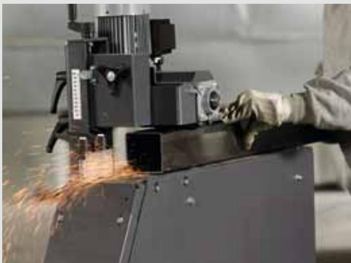
Anche la levigatura longitudinale di profili, materiali piatti o quadri risulta sorprendentemente semplice con il modulo di smerigliatura per superfici piane GIL, come facile è la trasformazione da levigatrice a nastro a smerigliatrice per superfici piane, e viceversa. Tutto ciò senza modificare le dimensioni del nastro abrasivo della macchina base. Per questa soluzione GRIT è stata depositata domanda di brevetto.
