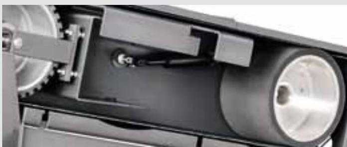
La tensione regolata mediante molla a gas compensa automaticamente le tolleranze dimensionali dei nastri. Grazie alla puleggia rivestita in poliuretano, il nastro viene tensionato in maniera ottimale – senza rischio di slittamento.
