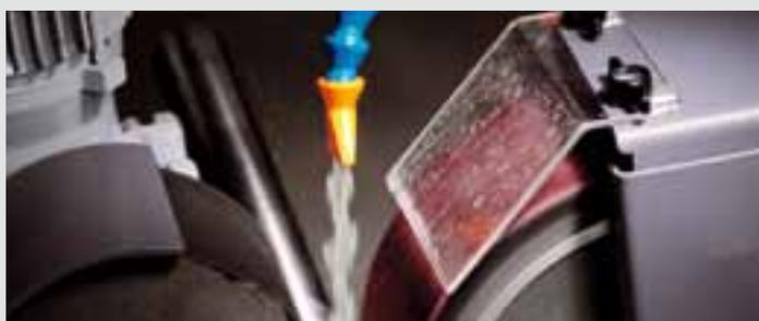
La levigatura a umido con il modulo di lubrorefrigerazione GRIT GXW assicura risultati superficiali decisamente migliori: il pulviscolo di levigatura viene immediatamente legato e il raffreddamento incrementa la durata dei nastri abrasivi. Inoltre, grazie al minor sviluppo di calore durante la levigatura, si riduce il rischio di corrosione dei tubi in acciaio inox. L'impianto a circuito chiuso è inoltre garanzia di un consumo contenuto del liquido lubrorefrigerante.
