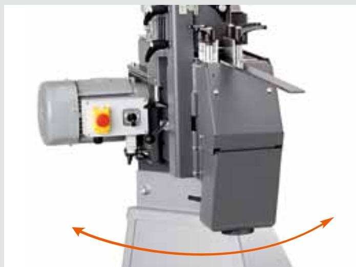
Grazie al supporto orientabile GIT (opzionale, numero d'ordine 6 99 02 176 00 0) e alla struttura modulare della macchina, è possibile sfruttare al meglio il modulo GIL anche in situazioni nelle quali lo spazio a disposizione è limitato. Il campo di rotazione è regolabile in continuo da 0° a 90°.
