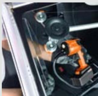
L'éclairage LED de la télécommande et les déflecteurs transparents permettent de suivre en permanence le cheminement du fil de coupe.
