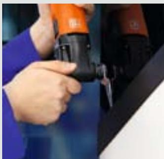
Démontez proprement le cadre enjoliveur collé, avec les couteaux droits de forme 081 et 216, rapidement et en toute fiabilité. Vous pouvez ainsi réutiliser le cadre dans la plupart des cas. Vitesse recommandée : position 3-5.
