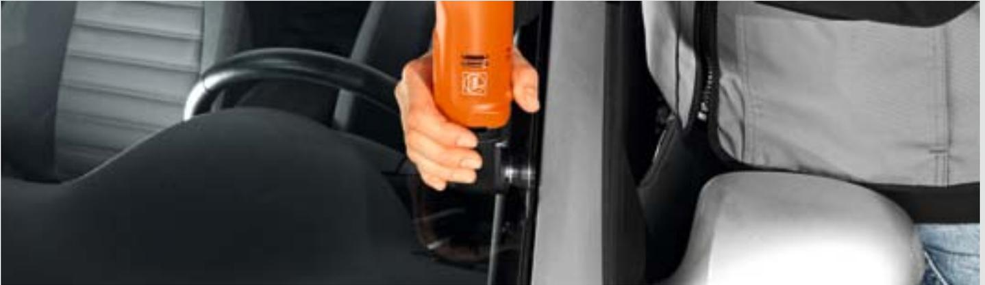
Coupe extrêmement rapide: le couteau en L forme 207 présente une puissance de coupe 40 % supérieure à vitesse égale par rapport à un couteau en U comparable. Un avantage de taille pour la dépose de pare-brise de l'extérieur. Vitesse recommandée: position 3-4.
