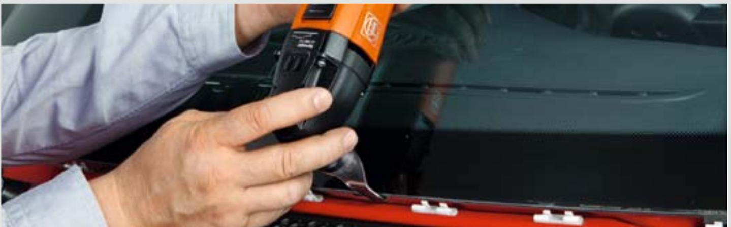
Les couteaux en U permettent la dépose de vitrages par-dessous le capot du moteur. Vitesse recommandée : position 3-5
