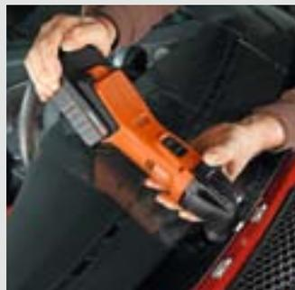
Les couteaux en U renforcés permettent la dépose de vitrages par-dessous le capot du moteur. Vitesse recommandée: position 3-4.
