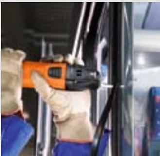
Dans le cas des vitres d'autobus, les joints doivent être enlevés en effectuant une coupe en V avant que ne soit déposée la vitre. Grâce à sa coupe rapide, le couteau droit de forme 073 s'y prête à merveille. Vitesse recommandée : position 3-5.
