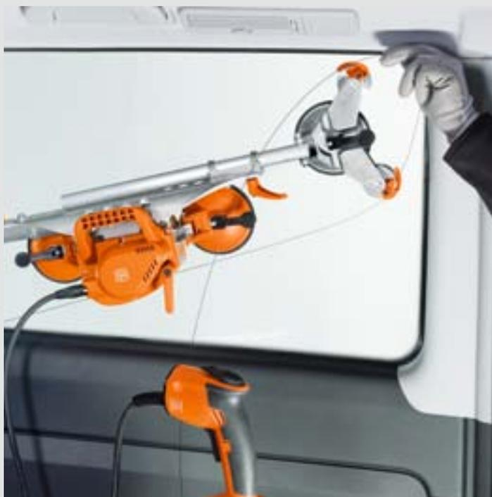
Dépose facile de grandes vitres latérales sans repositionnement. Toujours commencer l'insertion du fil dans le coin supérieur droit.
