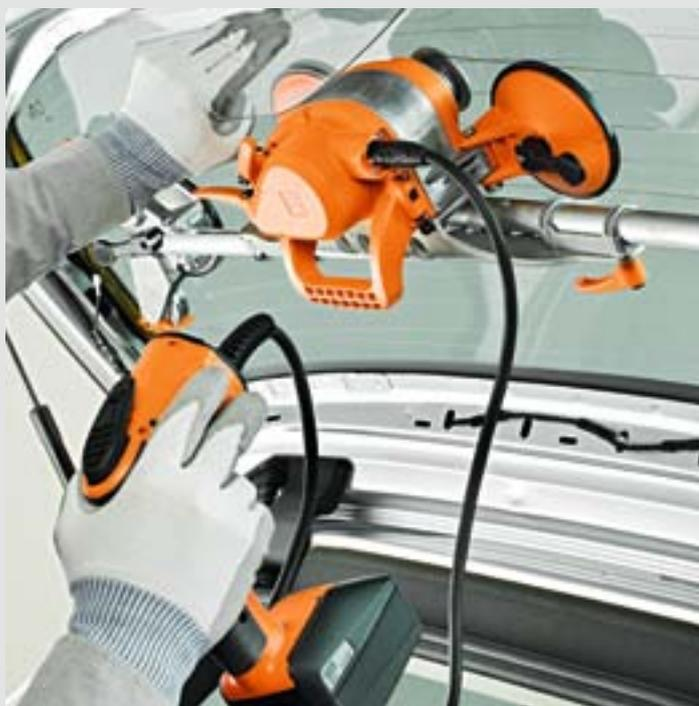
Dans le cas de lunettes arrière basses, comme celles de breaks par exemple, le SUPERWIRE est monté parallèlement à la vitre.
