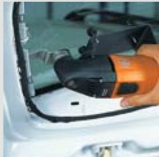
Les vitres arrière et latérales de certains modèles VAG sont équipées de cadres non vulcanisés. FEIN propose la solution parfaite pour le démontage fiable des vitres des modèles VW Passat jusqu'à 2004, de VW Polo jusqu'à 2001, Lupo, Seat et VW Golf III.
