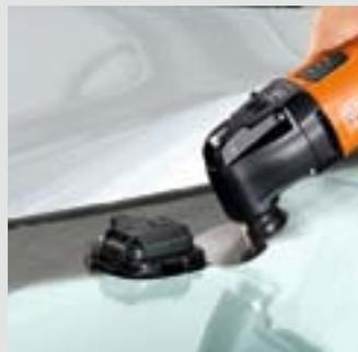
La nouvelle gamme d'accessoires est également adaptée à l'exécution d'autres tâches. Le couteau champignon permet, entre autres, la dépose facile des capteurs d'éclairage et d'essuie-glaces des véhicules modernes. Vitesse recommandée: position 2-3.
