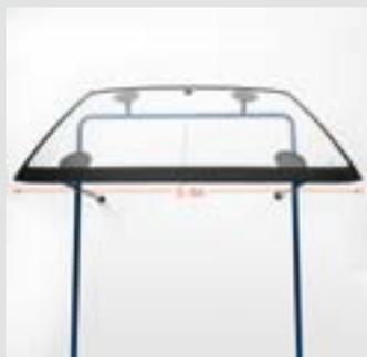
La longueur de fil nécessaire correspond à 5 à 6 fois la largeur totale inférieure de la vitre. Une longueur de fil de 2 à 2,5 fois la largeur intérieure du véhicule doit être insérée dans l'habitacle avec l'aiguille d'amorce.
