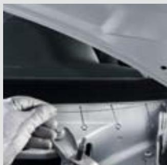
Si la vitre dépasse du flanc de la carrosserie, il est recommandé d'utiliser des aiguilles en métal pour s'assurer que le fil reste au plus proche de la vitre lors de la coupe.
