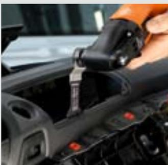
Les lames de scie E-CUT avec denture bi-métal sont parfaites pour le sciage dans les endroits exigus ou arrondis de carrosserie, comme on en trouve lors de la réparation ou des transformations automobiles (par exemple lors de l'installation d'appareils de navigation).
