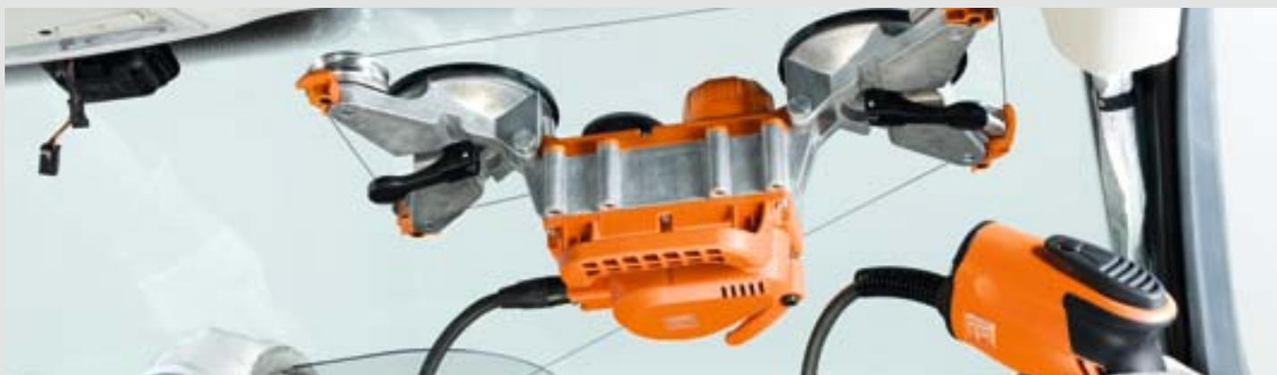
Lorsqu'il vous est impossible de monter le SUPERWIRE avec les bras télescopiques, il vous faut le repositionner une fois au cours de la dépose. Le SUPERWIRE est fixé en haut à droite après l'insertion du fil. Le cordon de colle est coupé jusqu'à l'arrêt supérieure de la vitre. Le SUPERWIRE est ensuite repositionné du côté gauche pour terminer la dépose.
