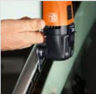
Pour les jeux d'assemblage étroits (min. 3 mm), utilisez les couteaux en forme de L 207 et 208 de 25,4 ou 19 mm. Ces formes courtes rendent inutiles le démontage des garnitures intérieures des montants de baie.
