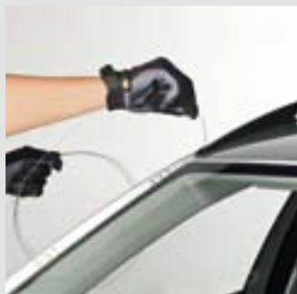
Le fil est simplement roulé sous les baguettes vulcanisées, leur évitant tout dommage lors de la dépose et permettant la réutilisation de la vitre.
