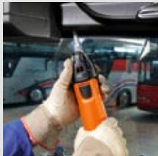
Le couteau de forme 081 peut également être utilisé pour déposer les vitres de très grande taille de l'intérieur. Vitesse recommandée : position 3-5.
