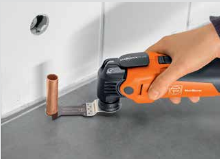
E-CUT-sågblad för nästan alla material.
