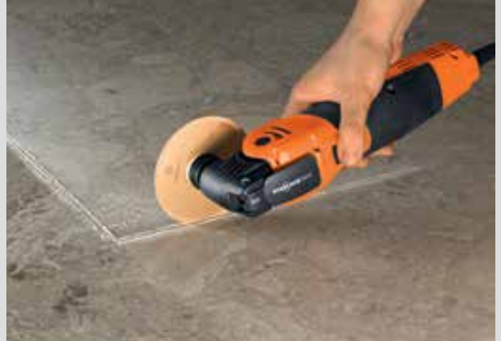
Den endast 1,2 mm breda hårdmetallsågklingan för mycket smala fogar.
