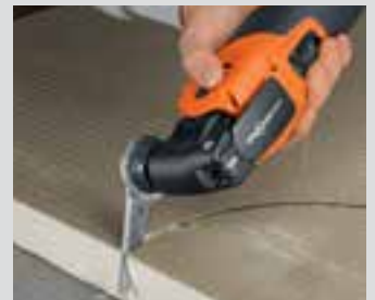
Skära till byggskivor.
