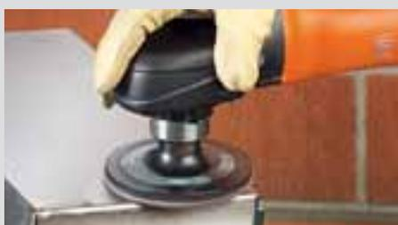
Anlauffarben effektiv entfernen mit dem Wellenvlies oder der Vliesscheibe. Für optimale Anpassung an Schweißnähte.
