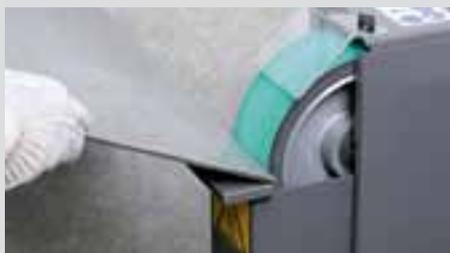
Schweißnahtvorbereitung nahezu vibrationsfrei, höchste Abtragsleistungen und geringe Werkzeugkosten: mit GRIT Schleifbandqualität „R“.
