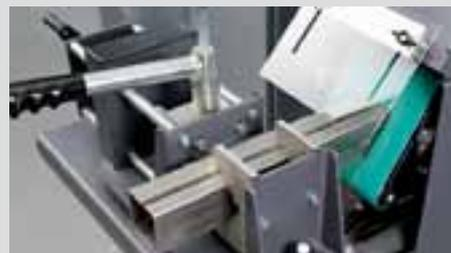
Exakte Gehrungsschliffe durch Gehrungsschleifplatte in Verbindung mit GIR.
