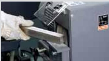
GRIT Entgratmaschinen mit Edelstahlbürsten zum rationellen Entgraten handlicher Werkstücke.
