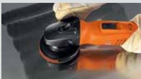
Optimale Vorbereitung für das Polieren von Flächen. Abgestimmter Schliffbildaufbau im Rotationsverfahren.
