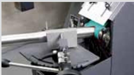
Passgenaues Ausschleifen von Radien in Sekundenschnelle mit GRIT Radienschleifmodulen.
