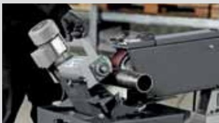
GRIT Rundschleifmodul GIC: Schliffbildaufbau zur Poliervorbereitung an Rohren.
