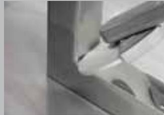
Kehlnähte lassen sich mit der Filzscheibe und den Polierpasten bis zum Spiegelglanz polieren.
