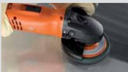
Punktuelles Ausschleifen leichter Kratzer mit Finishing-scheibe. Bei tieferen Kratzern Schleifscheiben „Pyramix“ mit Kletthaftung.
