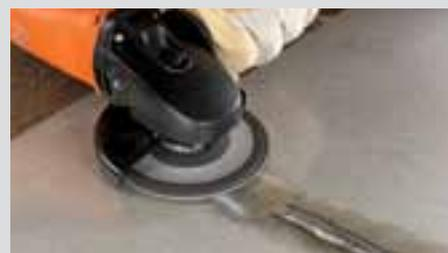
Mit hohem Drehmoment, aber drehzahlreduziert Schleifen mit Fächerscheiben. So wird hohe Hitzebildung am Werkstoff vermieden.
