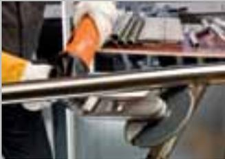
Anlaufarben lassen sich mit der Vliesscheibe (fein) ohne Beschädigung angrenzender Bauteile schnell entfernen.
