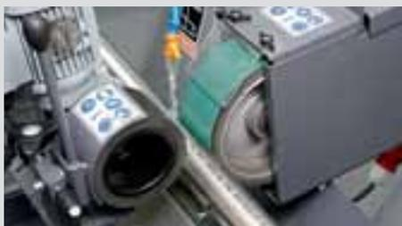
Kratzer werden in einem automatisierten Prozess entfernt.
