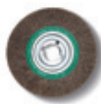
Stålbörste Ø 250 mm x 60 mm, tråd med stor draghållfasthet ger kostnadseffektiv användning, fästhåls-Ø 51 mm. 0,2 mm trådtjocklek för tunnväggiga rör och profiler. 0,5 mm trådtjocklek för allroundanvändning. 0,5 mm trådtjocklek för tjockväggiga rör och profiler och stor avgradningskapacitet. Rostfritt utförande
