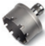
HM-hålsåg för rör med QuickIN-PLUS-fäste Hårdmetallbelagd med optimal livslängd vid användning på rörmaterial och välvda ytor med väggdjocklekar upp till 4 mm. Borrhjup 4 mm.
