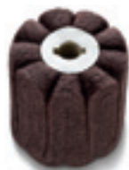
Slijpvlieswals Sinus Boorgat 19 mm Ø 100 x 100 mm, met sinusas, voor satijnfinish zonder aanzetten
