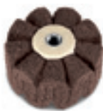
Slijpvlieswals Sinus Boorgat 19 mm Ø 100 x 50 mm, met sinusas, voor satijnfinish zonder aanzetten
