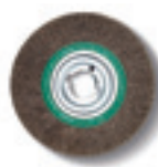
Staalborstel Ø 250 mm x 60 mm, met zeer hoge draadtreksterkte voor uiterst rendabel gebruik, opnameboorgat Ø 51 mm. 0,2 mm draaddikte voor dunwandige buizen en profielen. 0,35 mm draaddikte voor universeel gebruik. 0,5 mm draaddikte voor dikwandige buizen en profielen en hoge afbraamcapaciteit. RVS-uitvoering
