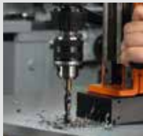
Spiralbohren mit Bohrfutter
