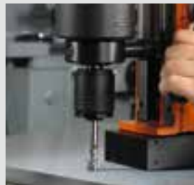
Gewindebohren mit Gewindebohrapparat
