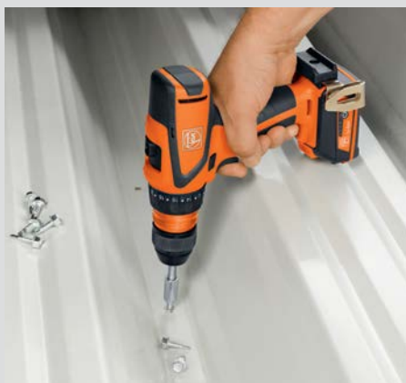
Vitesses de rotation optimales pour vis autoperçantes.
