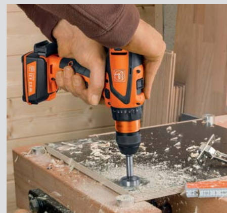
Perfekt för monteringsjobb, t.ex. justerbara gångjärn med gångjärnsborr.
