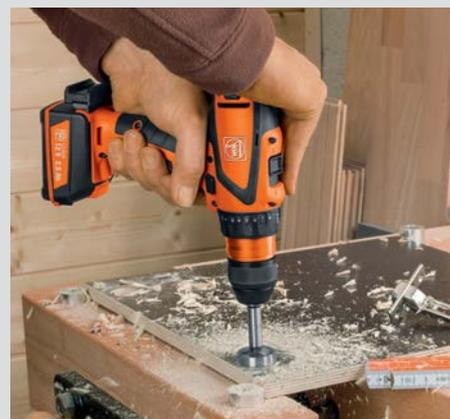
Ideal für Montagearbeiten z. B. Einbau von Topfscharnieren mit Forstnerbohrer.
