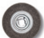
Stålbørste Ø 250 mm x 60 mm, med svært høy trådtrekkefasthet for ekstra driftsøkonomisk bruk, feste hull Ø 51 mm. 0,2 mm trådykkelse for rør og profiler med tynne vegger. 0,35 mm trådykkelse til universell bruk. 0,5 mm trådykkelse for tykke rør og profiler samt god avgrading. Ståltøfelse
