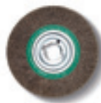
Rustfri stålbørste Ø 250 mm x 60 mm, med svært høy trådtrekkefasthet for ekstra driftsøkonomisk bruk, feste hull Ø 51 mm. 0,2 mm trådykkelse for rør og profiler med tynne vegger. 0,35 mm trådykkelse til universell bruk. Utførelse i rustfritt stål
