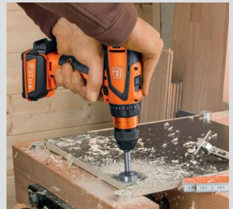
Ideal für Montagearbeiten z. B. Einbau von Topfscharnieren mit Forstnerbohrer.
