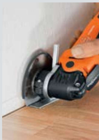
Pontos perem közeli munkavégzés mélységátarolóval is.
