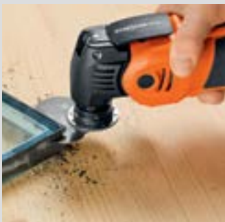
Szigetelő üveglapok szétválasztása.
