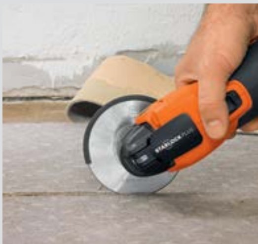
Régi padlóburkolatok gyors, egyszerű és maradék nélküli eltávolítása.
