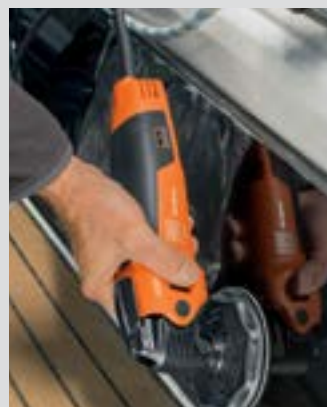
Akril és polikarbonát felület felújítása.
