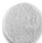
Лента Шлифовальная Щеточные накладки для очистки или полировки корпусов судов и палуб (Ø 195 мм), для тарельчатых шлифовальных кругов (Ø 170 мм), 6 38 06 187 01 0 М 14, с креплением-липучкой. Для противоскользких структур из стеклопластика. Рекомендуемая рабочая частота вращения – прибл. 500 об/мин.
