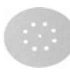
Диски из абразивной шкурки перфорирован., Ø 150 мм, с быстросъемным креплением на липучке Области применения: Металл, автошасси трубчатые, места спаяк, сварок, стеклопластик. Качество: Износостойкое шлифовальное сукно, на связке из искусственных смол, корунд. Свойства: весьма стабильный высокий съем материала.
