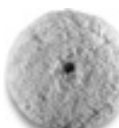
Tarcza wełniana Średnica ok. 230 mm do talerza szlifierskiego Ø 170 mm 6 38 06 187 01 0 M 14 z mocowaniem na rzep. Zalecana robocza prędkość obrotowa 500-1 200 obr./min. Jakość TOPWOOL, tarcza polerska Frisbee. Mieszanka wełny jagnięcej/ włókien syntetycznych, możliwość prania.
