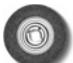
Rustfri stålborste Ø 250 mm x 60 mm, med svært høy trådtrekkefasthet for ekstra driftsøkonomisk bruk, festehull Ø 51 mm. 0,2 mm tråddykkelse for rør og profiler med tynne vegger. 0,35 mm tråddykkelse til universell bruk. Stålutførelse
