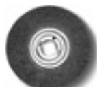
Rustfri stålborste Ø 250 mm x 60 mm, med svært høy trådtrekkefasthet for ekstra driftsøkonomisk bruk, festehull Ø 51 mm. 0,2 mm tråddykkelse for rør og profiler med tynne vegger. 0,35 mm tråddykkelse til universell bruk. Utførelse i rustfritt stål
