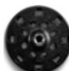
Slipedisk m/borrelås Med borrelåsfeste, Ø 150 mm med avsgulshull M14. Hullsirkel egnet for FEIN og andre slipemidler
