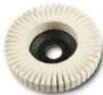
Zum Polieren und Vorpolieren von Edelstahl. Durch die Lamellen „verbrennt“ der Filz nicht und es kann ohne Streifenbildung poliert werden. Nur mit Polierpaste verwenden (Vorpolieren = Vorpoliercreme, Hochglanzpolieren = Abglänzcreme).
