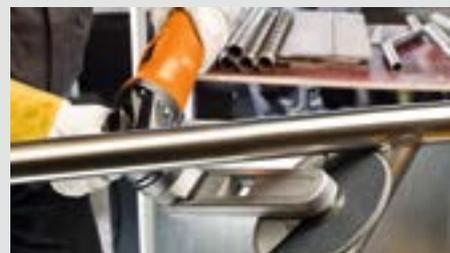
Kehlnähte bearbeiten: vom Verschleifen der Schweissnähte bis zum Spiegelglanz.
