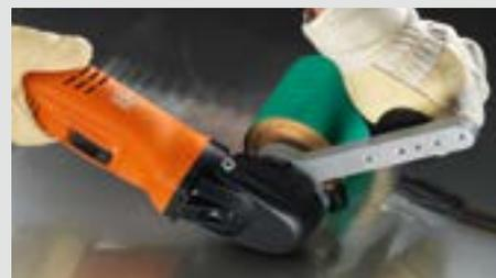
Flächenschleifen mit Schleifhülsen für überragende Abtragsleistung.
