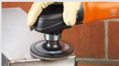
Anlauffarben effektiv entfernen mit dem Wellenvlies oder der Vliesscheibe.
