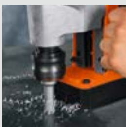
Perçage par carottage
