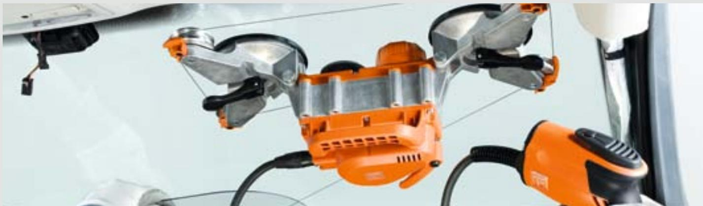
Si no puede montar el SUPERWIRE con los brazos telescópicos, deberá cambiarse una vez de posición. Tras insertar el alambre, el SUPERWIRE se fija en la parte superior derecha. El cristal se separa hasta el canto superior y después el SUPERWIRE se desplaza hacia la izquierda para separar el resto del cristal.
