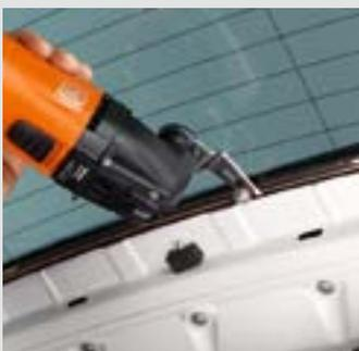
Con la cuchilla forma 143 y el rodillo de tope ajustable pueden extraerse desde el interior fácil y rápidamente tanto cristales laterales como lunas traseras. Velocidad recomendada: máx. nivel 3.
