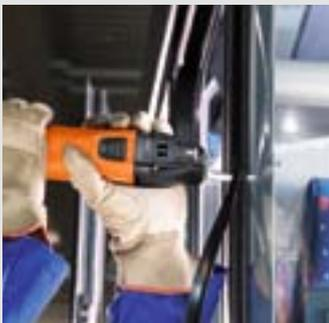
Los rellenos de las juntas en cristales de autobús deben eliminarse con un corte en V, antes de proceder a la extracción del cristal. Gracias a su rápido corte, resulta especialmente adecuado para la cuchilla recta forma 073. Velocidad recomendada: nivel 3-5.
