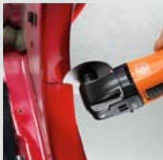
Con la hoja de sierra HSS podrá cortar rápidamente y sin proyectar chispas chapas de carrocería de hasta 1 mm, así como la mayoría de plásticos y plásticos reforzados con fibra de vidrio. El ancho de corte es de tan solo 0,5 mm. No adecuada para chapas de carrocería de alta resistencia. Velocidad recomendada: nivel 3-5.
