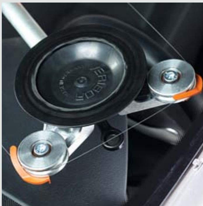
En caso de que una ventosa no se adhiera al cristal a causa de la curvatura del mismo, puede lograrse una mayor succión mediante el montaje del anillo de vacío.
