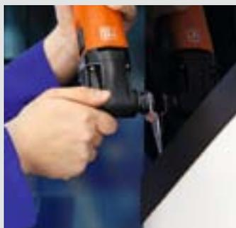
Los listones tapajuntas adheridos se pueden quitar con las cuchillas rectas forma 081 y 216 de forma limpia, fiable y rápida. De este modo, en la mayoría de los casos los listones se pueden volver a utilizar. Velocidad recomendada: nivel 3-5.
