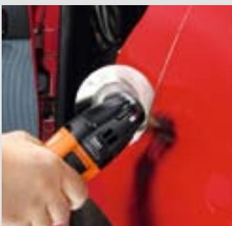
Con las hojas de sierra HSS podrá cortar rápidamente chapas de carrocería de resistencia normal hasta 1 mm así como piezas de plástico duro y plástico reforzado con fibra de vidrio. En ese caso, la línea de corte solo tiene 0,5 mm de ancho. Otras ventajas: corte sin proyectar chispas y profundidad de penetración individual en el material.
