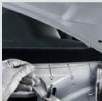
En caso de que el cristal se extienda sobre la brida de la carrocería, se recomienda utilizar las guías metálicas para que el alambre se sitúe en el cristal al cortar.
