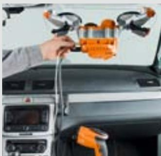
Con el cable que se suministra como accesorio, se activa el sistema Anti-Metal-Cut. Este sistema advierte mediante una señal acústica antes de que el alambre pueda dañar la carrocería.
