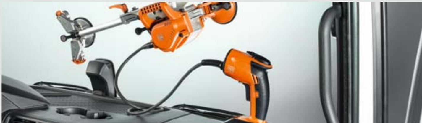
Mediante un único cambio de posición del SUPERWIRE, pueden extraerse de forma segura las lunas de camiones. En este caso, se empieza por el lado derecho del vehículo. De este modo, puede cortarse el adhesivo hasta aproximadamente el centro del techo interior. A continuación, debe desplazarse el SUPERWIRE hacia el lado izquierdo.
