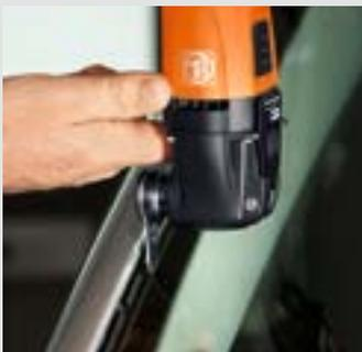
En el caso de medidas de hendidura estrechas (mín. 3 mm) se utilizan las cuchillas L 207 y 208 con 25,4 y/o 19 mm. Su forma corta puede ahorrarle tener que desmontar el revestimiento interior de las columnas A.
