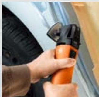
Con los accesorios de lijado podrá llevar a cabo sin esfuerzo pequeñas reparaciones como óxido, daños por golpes de piedras o daños en la pintura incluso en puntos de la carrocería de difícil acceso.
