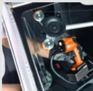
Con ayuda de la iluminación LED la unidad de control y las cubiertas transparentes, en todo momento puede seguirse la trayectoria del alambre de corte.
