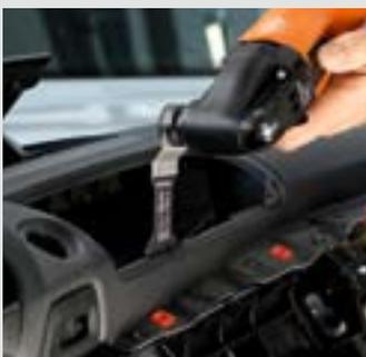
Las hojas de sierra E-CUT con dentado bimetálico resultan perfectas para el procesamiento de la carrocería –p. ej. en puntos o radios de difícil acceso, que surgen durante las reparaciones o reconstrucción de vehículos (p. ej. al montar aparatos de navegación)–.
