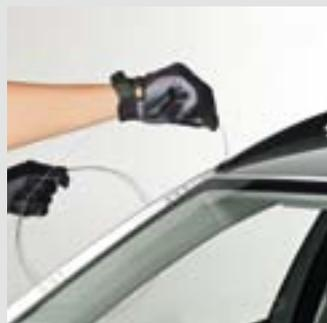
El alambre simplemente se enrolla debajo de los listones vulcanizados – de este modo, se evita que se dañen durante el desmontaje y el cristal puede volver a utilizarse.
