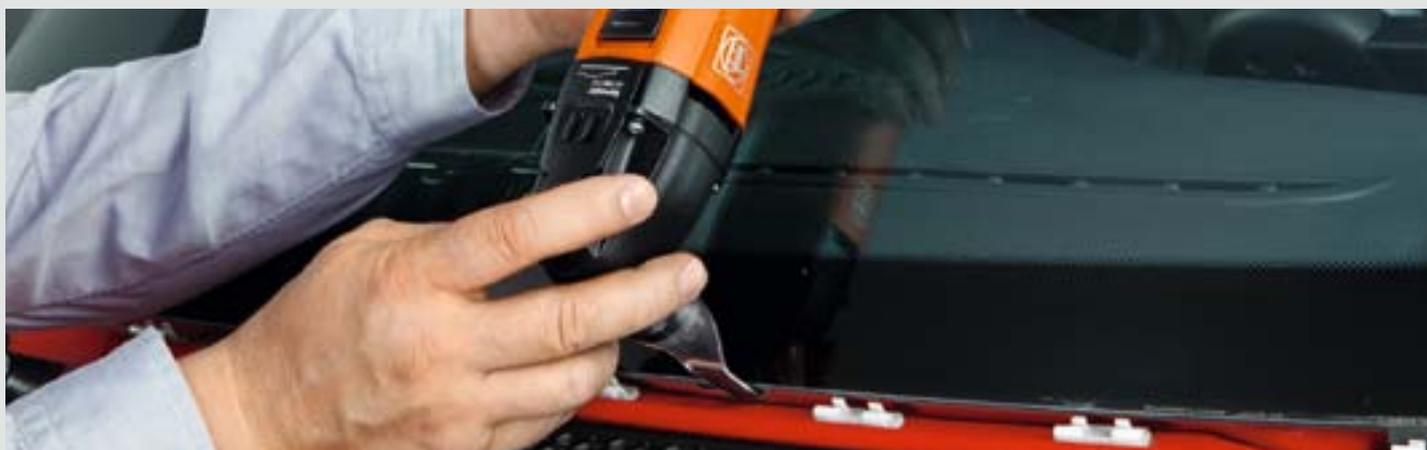
Para los cortes en la parte inferior del parabrisas se utilizan las cuchillas U. Velocidad recomendada: nivel 3–5
