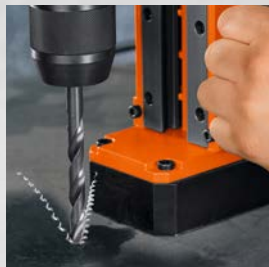
Perforación con broca espiral
