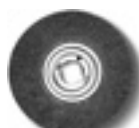
Staalborstel Ø 250 mm x 60 mm, met zeer hoge draadtreksterkte voor uiterst rendabel gebruik, opnameboorgat Ø 51 mm. 0,2 mm draaddikte voor dunwandige buizen en profielen. 0,35 mm draaddikte voor universeel gebruik. 0,5 mm draaddikte voor dikwandige buizen en profielen en hoge afbraamcapaciteit. RVS-uitvoering
