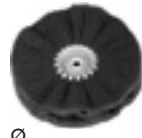
Schuurvlies met golfvouw, breedte ca. 30 mm, boorgat 14 mm, voor lichte ontbraamwerkzaamheden, desoxidatie, lichte schuurwerkzaamheden, decoratieve werkzaamheden
