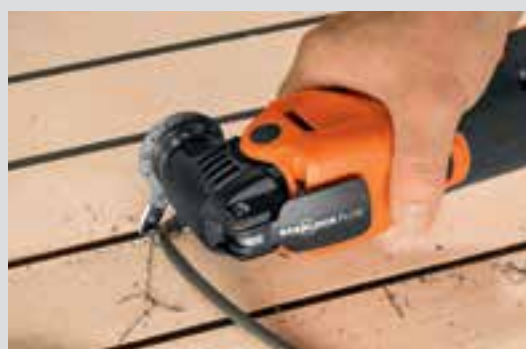
En tidsbesparelse på opptil 80 % ved fornyelse av teakdekk med nater.
