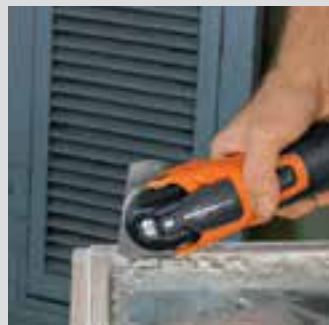
Oscillasjonsbevegelsen fjerner faren for at glasset knuser.
