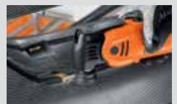
Fjerning av grader fra komponenter i karbonfiberarmert plast.
