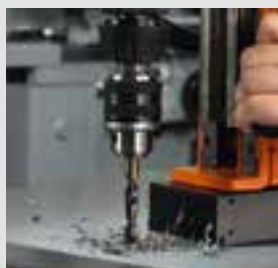
Spiralbohren mit Bohrfutter
