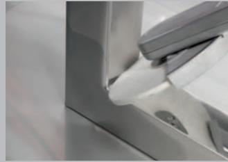
Con il disco in feltro e la pasta di lucidatura è possibile lucidare a specchio i cordoni di saldatura d'angolo.
