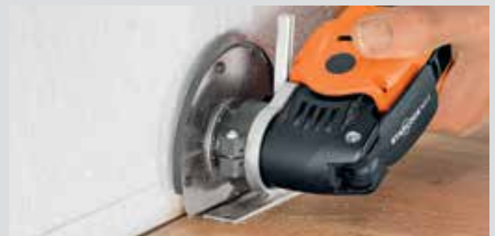
Uitzetvoegen kunnen uitstekend achteraf worden gesneden.
