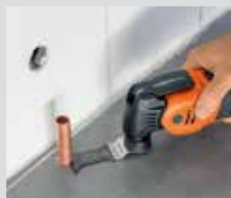
Oude installaties zonder problemen verwijderen.
