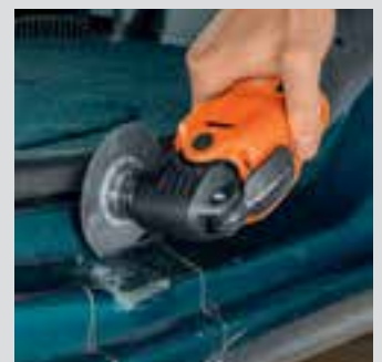
Zagen zonder vervormingen, zuivere zaagranden, dunne zaaglijn – een voordeel bij carrosseriewerkzaamheden.
