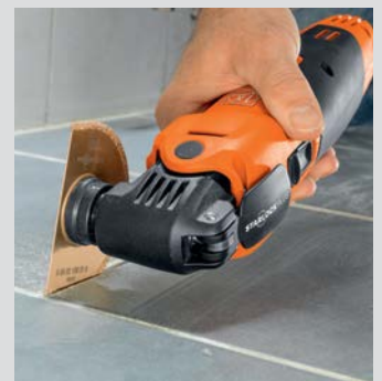
Les lames de scie de seulement 1,2 mm de large permettent aussi la dépose de joints très étroits.
