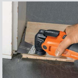
Travail au ras des surfaces.
