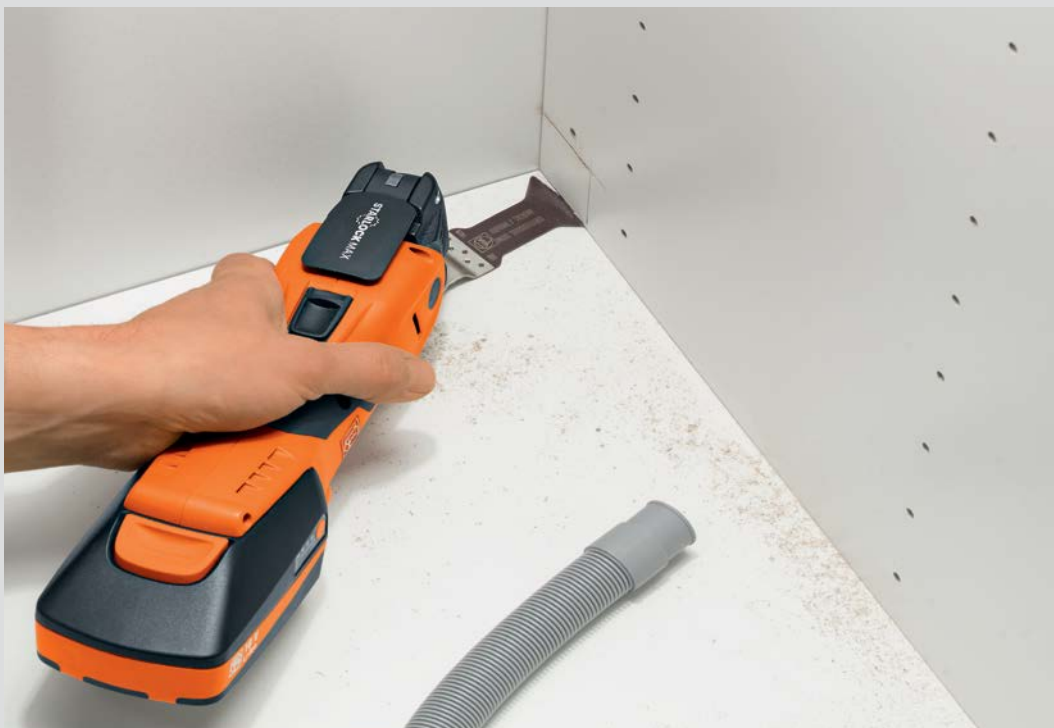
Évidements dans des meubles aux endroits difficiles d'accès.
