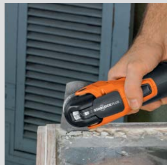
Aucun risque de bris de verre grâce au mouvement oscillatoire.
