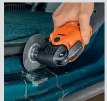
Sciage sans déformation, arêtes de coupe nettes, ligne de coupe fine – un avantage pour les travaux de carrosserie.
