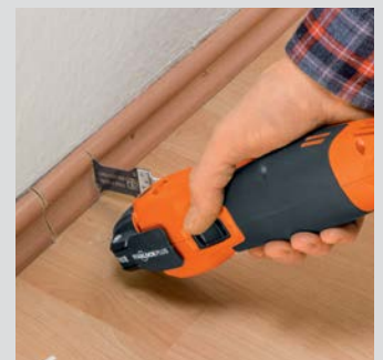
Aucun espace requis derrière la pièce à travailler.
