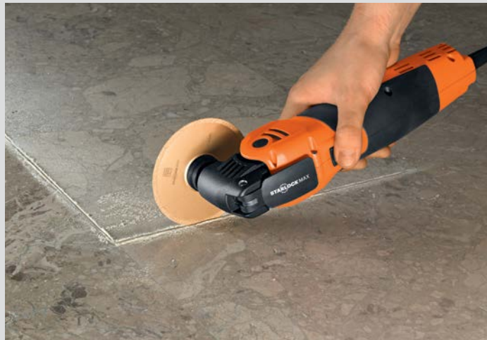
La lame à béton carbure d'une largeur de seulement 1,2 mm pour des joints très étroits.
