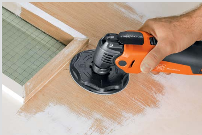
Le grand plateau de ponçage circulaire remplace les ponceuses supplémentaires telles que les ponceuses orbitales ou vibrantes.
