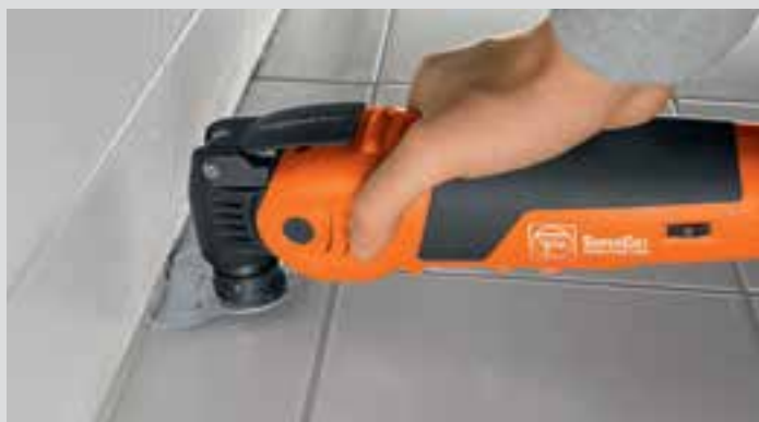
Rimozione di sigillante elastico.
