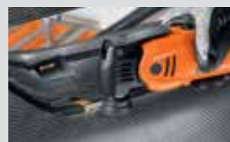
Sbavatura di componenti in fibra di carbonio.
