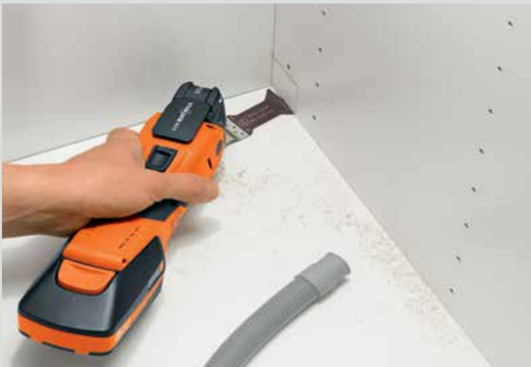
Aperture in mobili in punti difficilmente accessibili.
