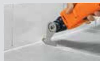
Lame segment diamantée pour les coupes dans les angles.
