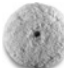
Peau de mouton Diamètre env. 230 mm pour plateau de ponçage Ø 170 mm 6 38 06 187 01 0 M 14 avec fixation auto-agrippante. Vitesse de rotation recommandée 500-1200 tr/min. Qualité TOPWOOL, disque de polissage Frisbee. Mélange laine de mouton / synthétique, lavable.
