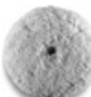
Cuffia in lana d'agnello Diametro circa 230 mm per platello con Ø 170 mm 6 38 06 187 01 0 M 14 con sistema di fissaggio a velcro. Numero di giri consigliato 500-1200 giri/min. Qualità TOPWOOL, disco di lucidatura Frisbee. Lana di agnello/ misto sintetico, lavabile.
