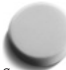
Polierschwamm Zum Polieren von lackierten Oberflächen. Unterschiedliche Härtegrade: weich für Neulacke, mittel für leichte Verwitterung und Wachsaufrag, hart für stark verwitterte Lacke. Kletten-schnellbefestigung, Höhe 40 mm.
