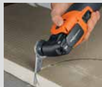
Разрезание строительных плит.
