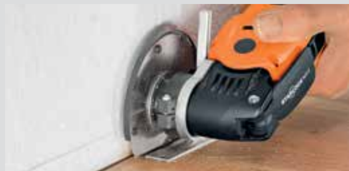
Оптимальная обработка деформационных швов.
