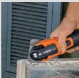
Благодаря осциллирующему движению отсутствует риск разбить стекло.
