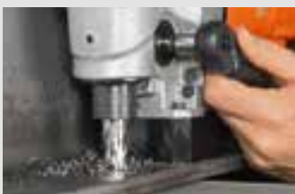
Perçage par carottage
