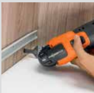
Til helt små udspæringer fra 10 mm.
