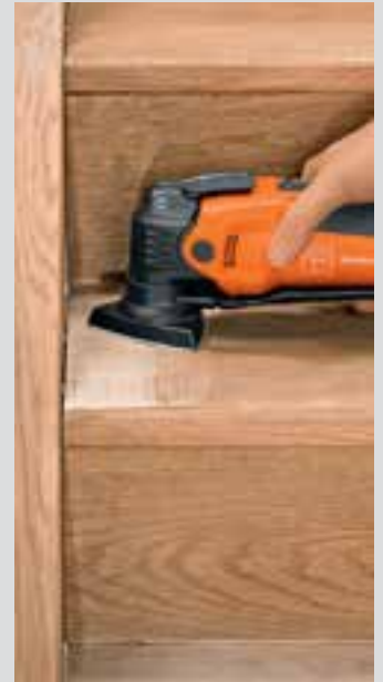
Slibning ved hjørner og kanter uden tilbageslag.
