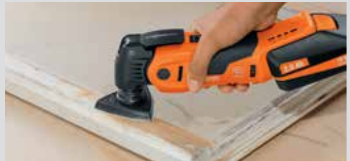
Slibning ved hjørner og kanter uden tilbageslag.
