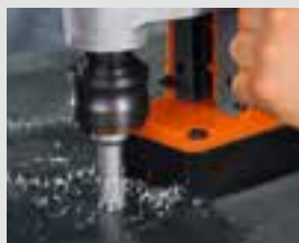
Perforación con corona
