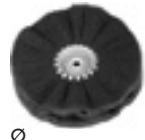
샌딩 플리스 물결 주름 있음, 폭 약 30 mm, 내경 14 mm, 가벼운 트리밍 작업과 탈산화, 가벼운 연삭 작업, 장식 작업
