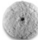
양모, 돔 모양 Ø170 mm 지지 패드용, 6 38 06 187 01 0, 지름 약 230mm, M14, 벨크로 부착 시스템. 권장 작동 속도 500-1 200 rpm. TOPWOOL 품질, 양털 폴리싱 휠. 양모/합성 섬유 혼합, 세척 가능.
