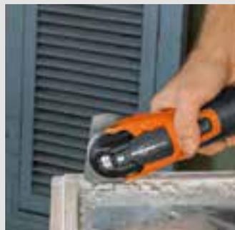
Durch Oszillationsbewegung keine Glasbruchgefahr.
