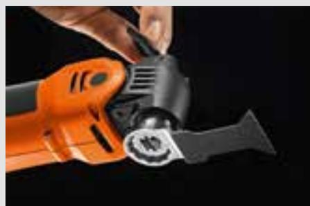
Zum Lösen den Spannhebel öffnen ...
