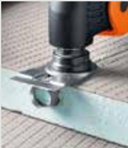
Kanäle für Warmwasser-Fußbodenheizung schneiden.
