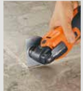
Diamant-Segmentmesser für Schnitte im Eckbereich.
