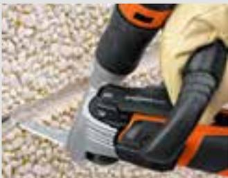
Bei gefährlichen Fugenmaterialien (z.B. PCB) kommt die Staubabsaugung zum Einsatz.
