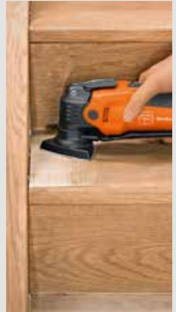
Schleifen an Ecken und Kanten ohne Rückschlageffekte.
