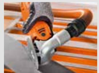
Perfekte Staubbeseitigung mit der Absaugvorrichtung.
