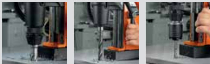
Perçage par carottage
