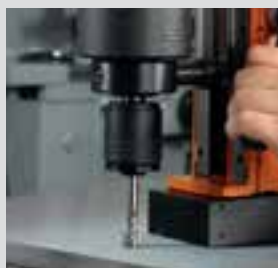
Taraudage avec dispositif de taraudage
