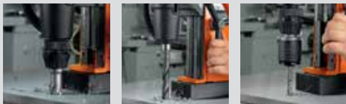
Perçage par carottage
