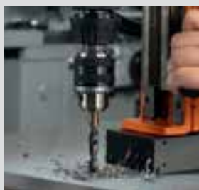
Perçage au foret hélicoïdal avec mandrin de perçage
