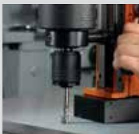
Taraudage avec dispositif de taraudage
